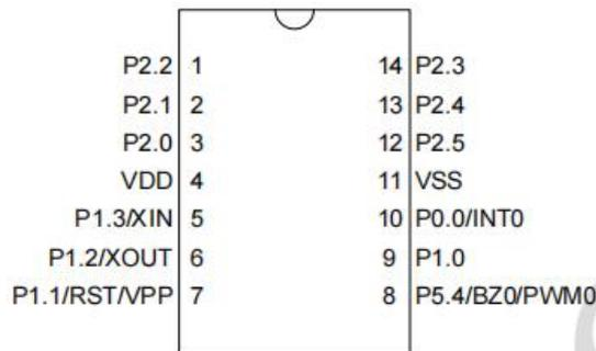
图 2-2 AiP8P005B- DIP14/SOP14 引脚排列图
